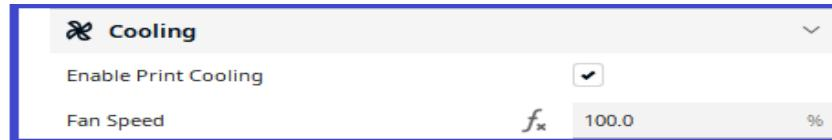
Omogućava ventilatore za hlađenje tokom štampe. Ventilatori poboljšavaju kvalitet štampe na slojevima sa kratkim vremenom nanošenja slojeva na ispuštimi- izbočenjima.
