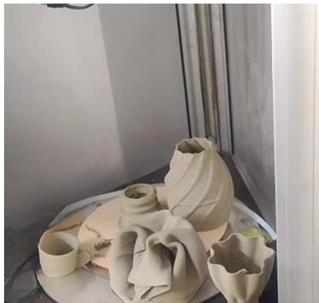
*Slika 6: Keramički predmeti napravljeni uz pomoć 3D štampača.*
