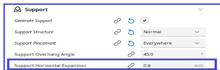
Pomeranje se može primeniti na potporne strukture u pravcima X i Y. Vrednosti veće od 1 čine potporne strukture šire od modela čime se dobija čvršća podrška.
