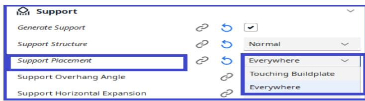
Prilagođava postavljanje strukture potpore. Postavljanje može biti podešeno na dodir sa radnom površinom ili svuda (Everywhere). Kada je postavljeno Everywhere, strukture potpora će se štampati i na modelu.
