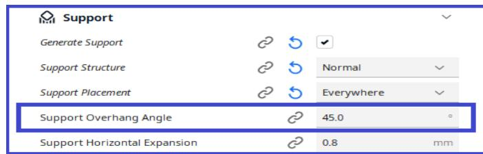
Minimalni ugao izbočenja za koji se dodaje potpora. Pri vrednosti od  $0^\circ$  sva izbočenja su podržana, dok  $90^\circ$  ne pruža nikakvu podršku.
