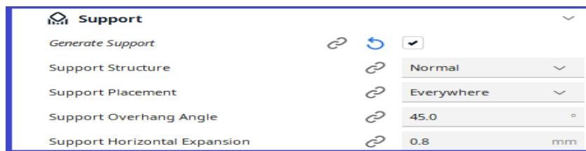
Generiše strukture za potporu delovima modela koji imaju izbočenja. Bez ovih struktura, takvi delovi bi se srušili tokom štampe. Softver će obeležiti crvenom bojom deo koji visi i kome je potrebna potpora.
